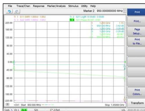
耦合端驻波及插损 (含测试夹具)
